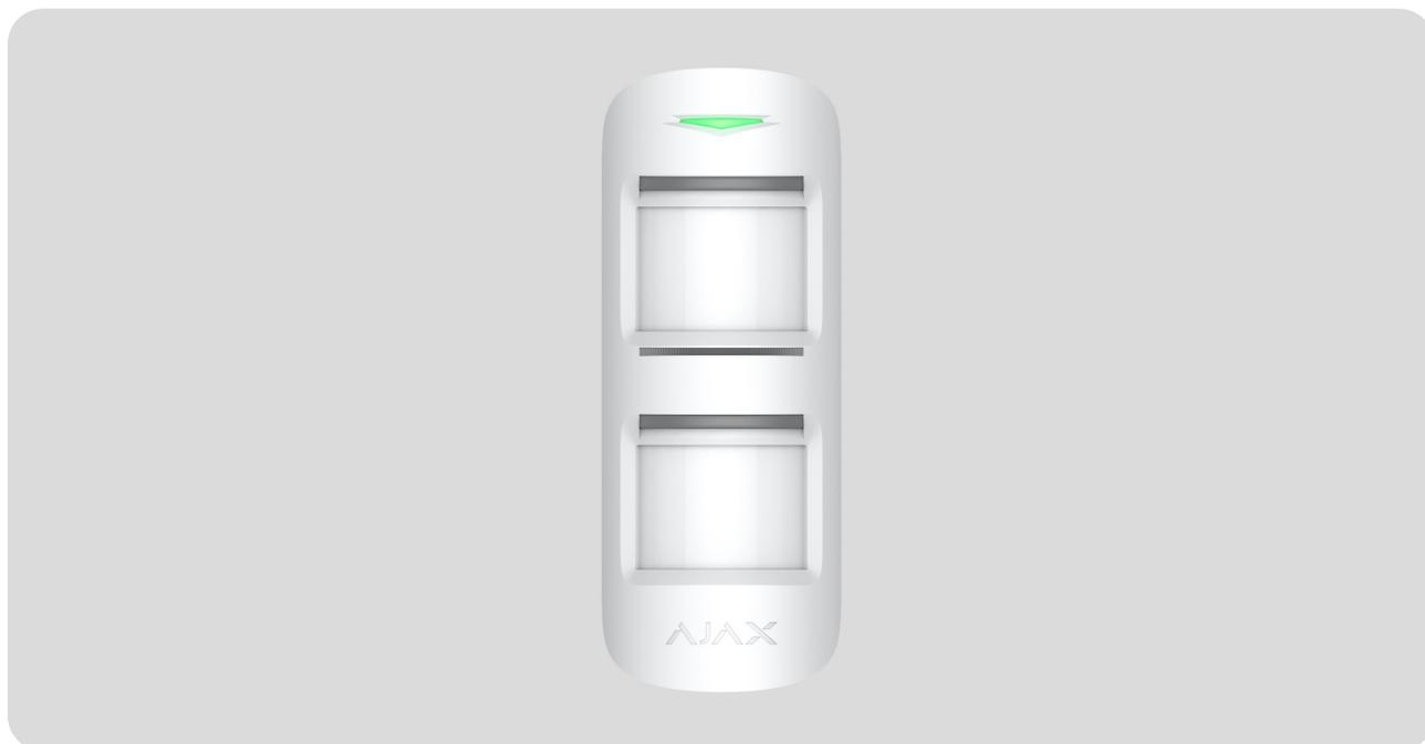
**MotionProtect Outdoor Jeweller** – бездротовий вуличний датчик руху. Має регульовану дальність виявлення руху до 15 метрів. Детектує спроби перекрити огляд датчика завдяки системі виявлення маскуванню. Датчик не реагує на тварин висотою до 80 см в разі коректного встановлення та налаштування.
