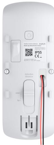
6. Вкладіть дроти в спеціальні канали та закріпіть їх комплектним кріпленням – пластиковим тримачем із шурупом.
